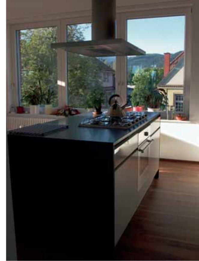
In der Küche der Maisonette- wohnung: Parkett-Fußboden mit vier Millimetern Nutzschrift verspricht Dauerhaftigkeit.
